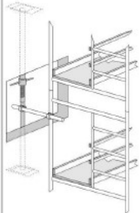
anclaje a puntal
