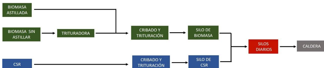
Ilustración 4: Diagrama de tratamiento y almacenamiento de combustibles.
