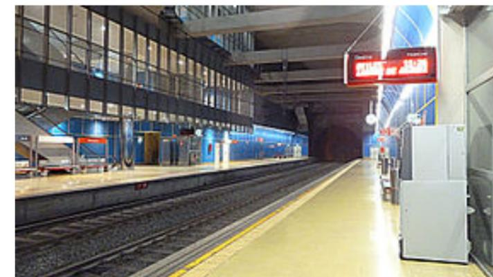
Tiene una superficie de 2.120 m<sup>2</sup>, los dos andenes, de 85 metros de longitud y 4,5 de ancho cada uno, se encuentran a 18 metros bajo el nivel de la calle.
