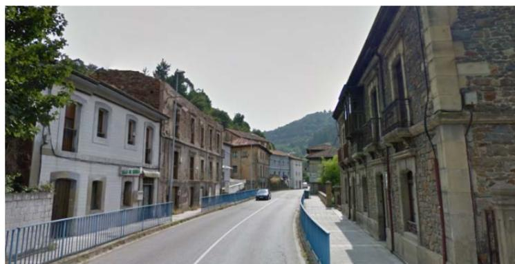
En la travesía ya existen semáforos de control de velocidad en las travesías (CVT) y barreras protectoras a ambos lados de la calzada que impiden la invasión del peatón a la calzada y del vehículo a la acera.
