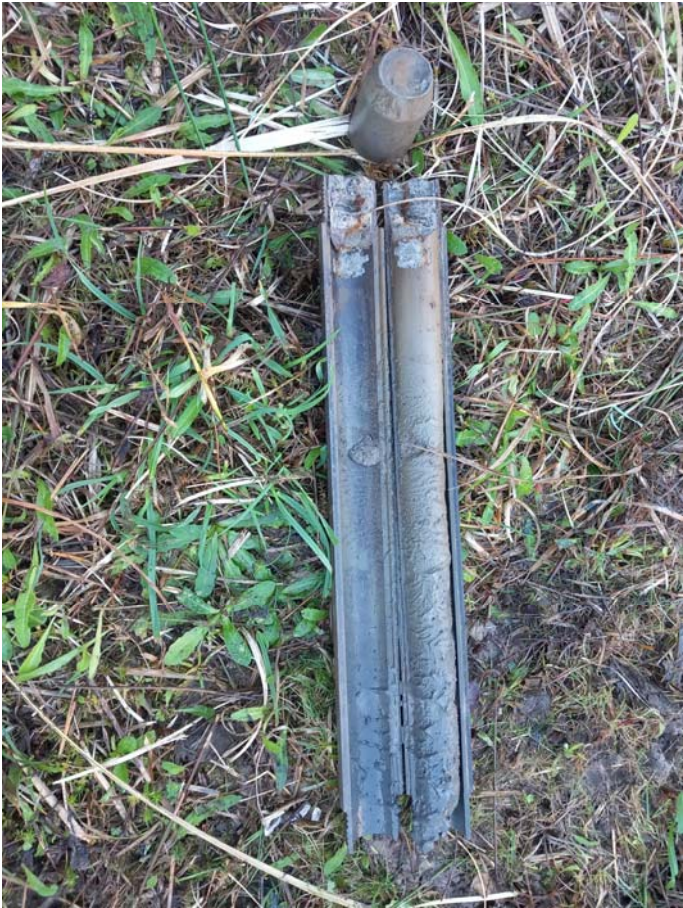
VISTA DEL TOMAMUESTRA ABIERTO DEL ENSAYO SPT, ENTRE 2,60 y 3,20 m de profundidad
