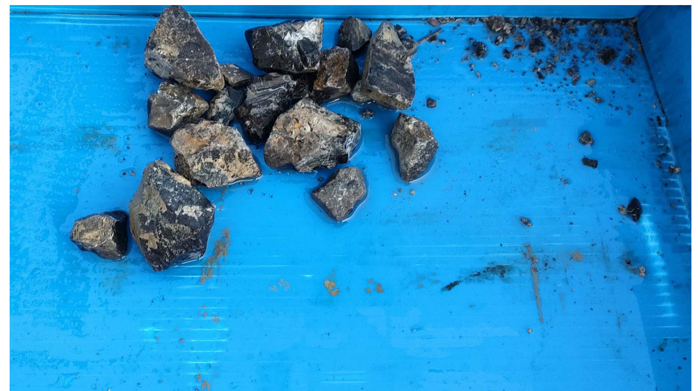
Imagen del tramo nº 1 del sondeo - Relleno lavado para su identificación
