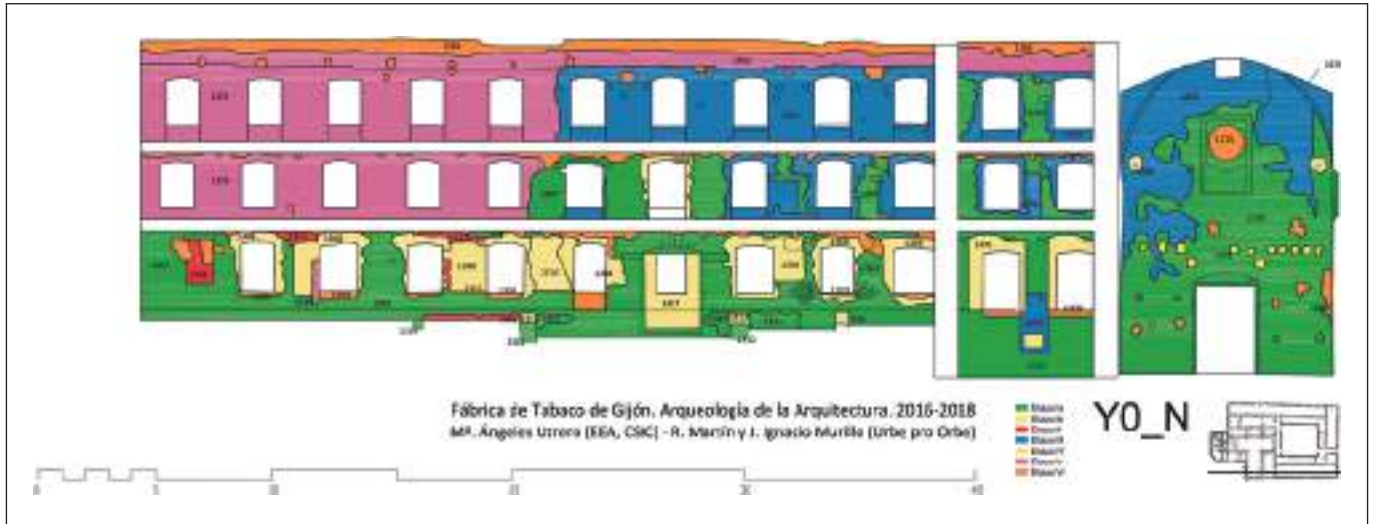
FIGURA 9: Lectura del paramento interior de la fachada sur del edificio (© Proyecto Tabacalera II, EST-AP, CSIC. Urbe pro Orbe).
