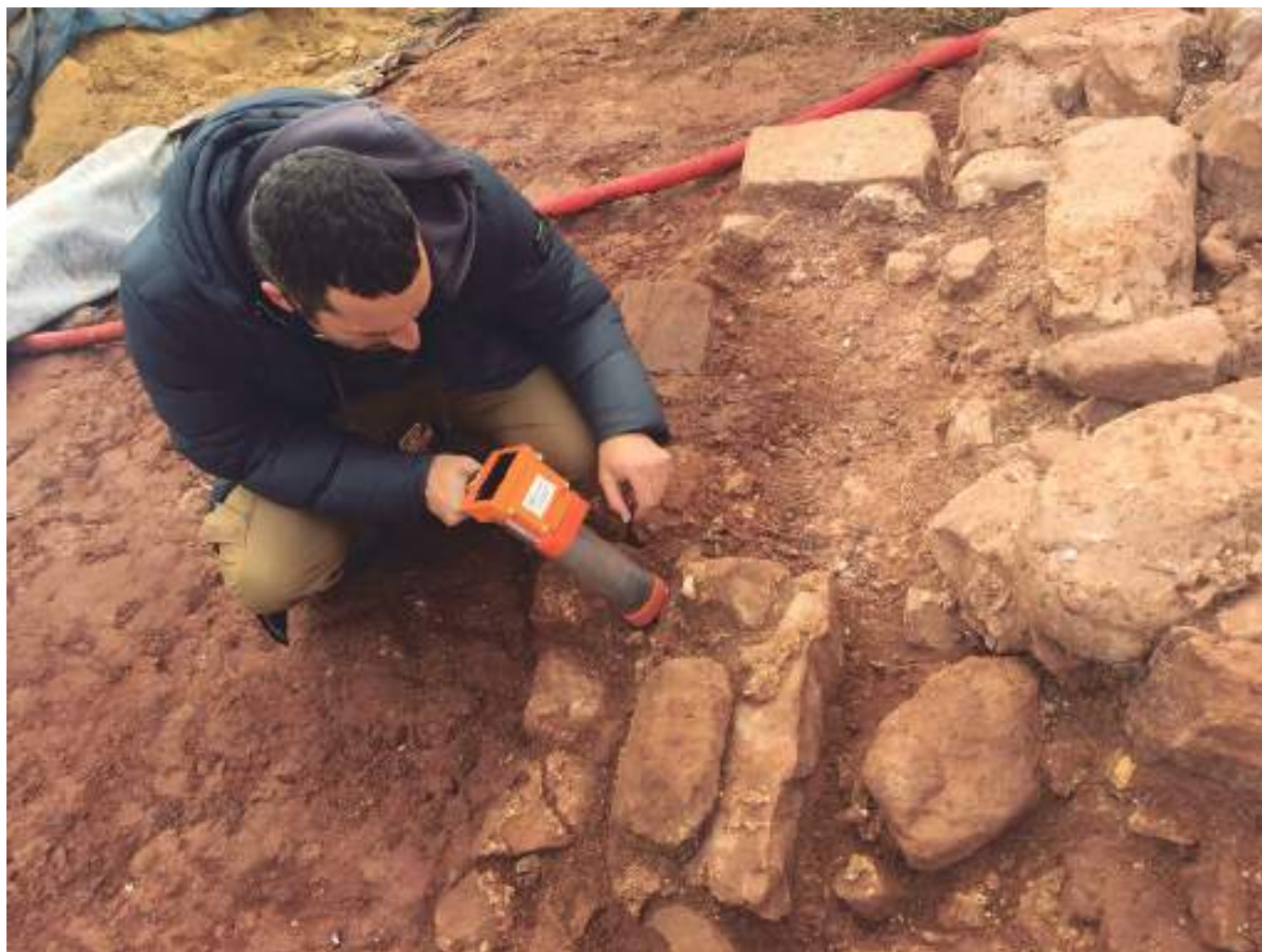
FIGURA 10: Mediciones de la tasa de radiación gamma en el punto de toma de una muestra con un espectrómetro de Rayos-gamma portátil GF Instruments Vario.
