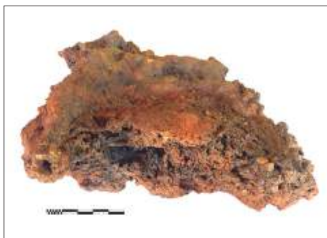
FIGURA 11: Muestra de escoria de refinado, caracterizada por su textura más heterogénea, con abundante porosidad y evidencias de corrosión.
