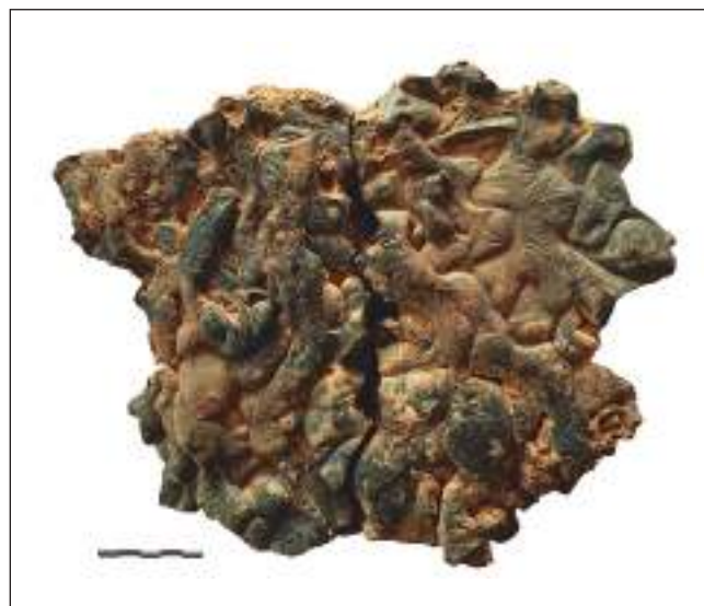
FIGURA 10: Muestra de escoria de sangrado. Su superficie evidencia el estado de fluidez viscosa en que se hallaba en su salida del horno.
