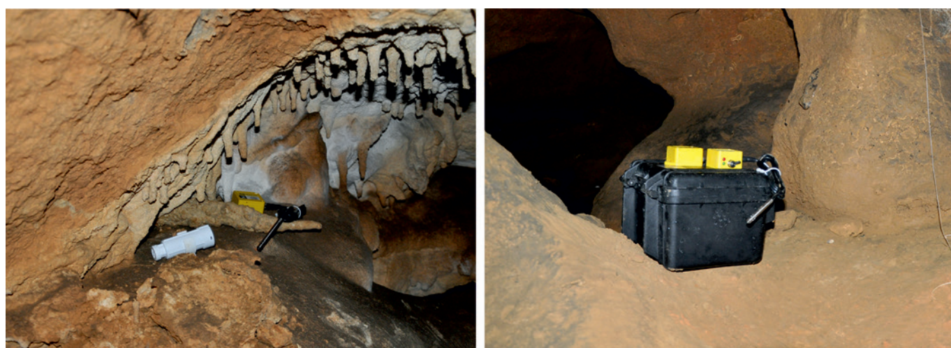
FIGURA II2: Ubicación en 2015 de los termohigrómetros en la Galería de las Pinturas (izda.) y en la Galería del Osario (dcha.).
