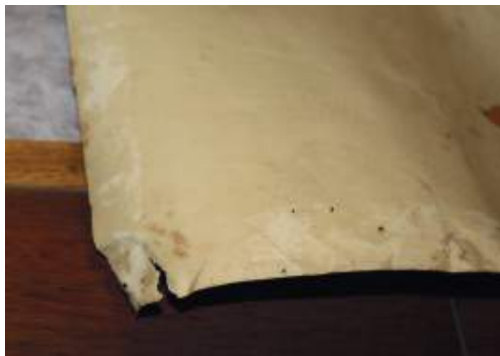
FIGURA 6. Rasgados, deterioros y perforaciones de chinchetas en los bordes de uno de los dibujos
